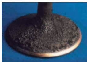
Zawór po 60 godzinach pracy na paliwie bez dodatków
